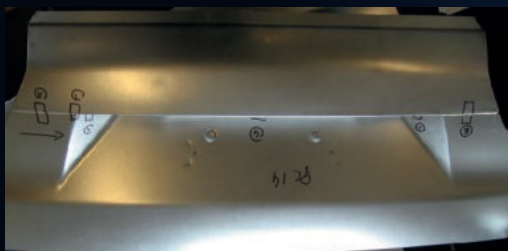
Joint de soudo-brasage d'une porte de coffre C5 Citroën
