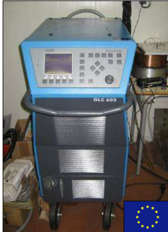
Source de soudage CLOOS Quinto GLC 603 CW-Pulsé / 500A FDM 100% Dévidage Push/Pull (régulation vitesse de fil)
