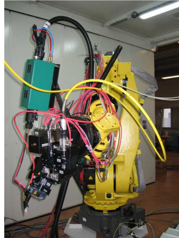
Soudo-brasage Scansonic ALO3 (suivi de joint dans le fil)
