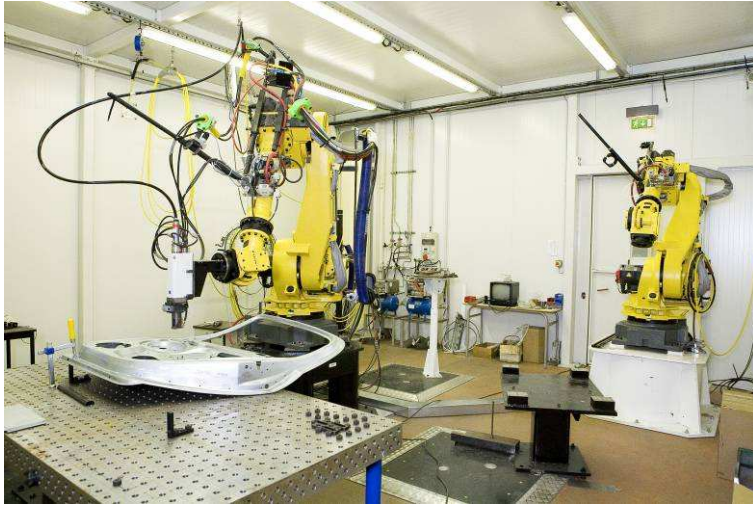
2 x Robots Fanuc R2000iA/165F Rayon d'action 2,65m / Payload 165 Kg
