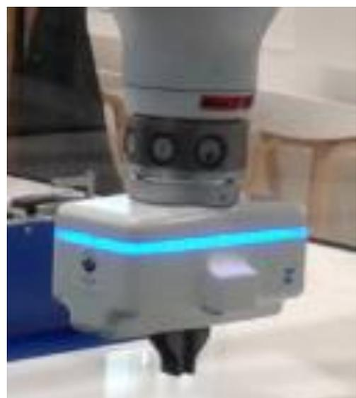
Les pinces sont de plus en plus asservies électriquement. Leurs performances sont équivalentes aux actionneurs pneumatiques et elles offrent un gain important en encombrement dans l'environnement du robot.
