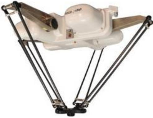
Certainement le plus rapide robot DELTA du moment avec une possibilité de 300 saisies par minute, Omron propose le Quattro qui possède quatre bras. Cette innovation lui permet de travailler dans une plus grande zone et lui offre la possibilité de placer la charge à un angle différent de celui de la saisie.
