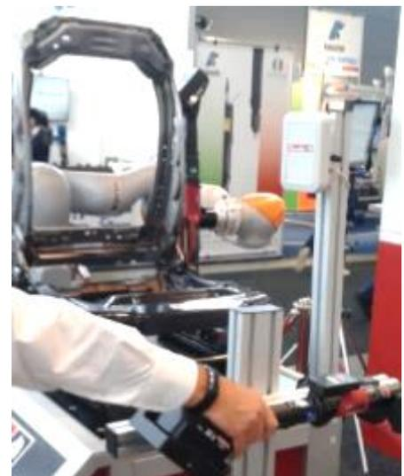
Autre illustration dans le domaine automobile (assistance à une opération vissage bloc moteur) sur le stand Kuka ...
